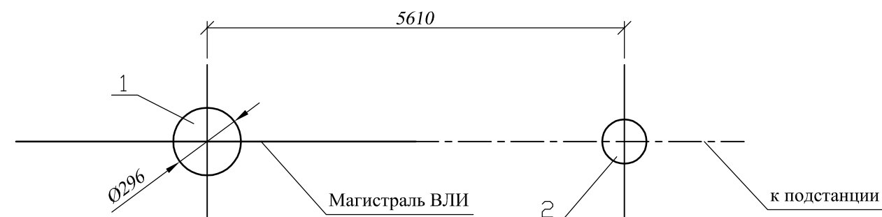
Схема основных котлованов для установки стойки и подкоса опоры
