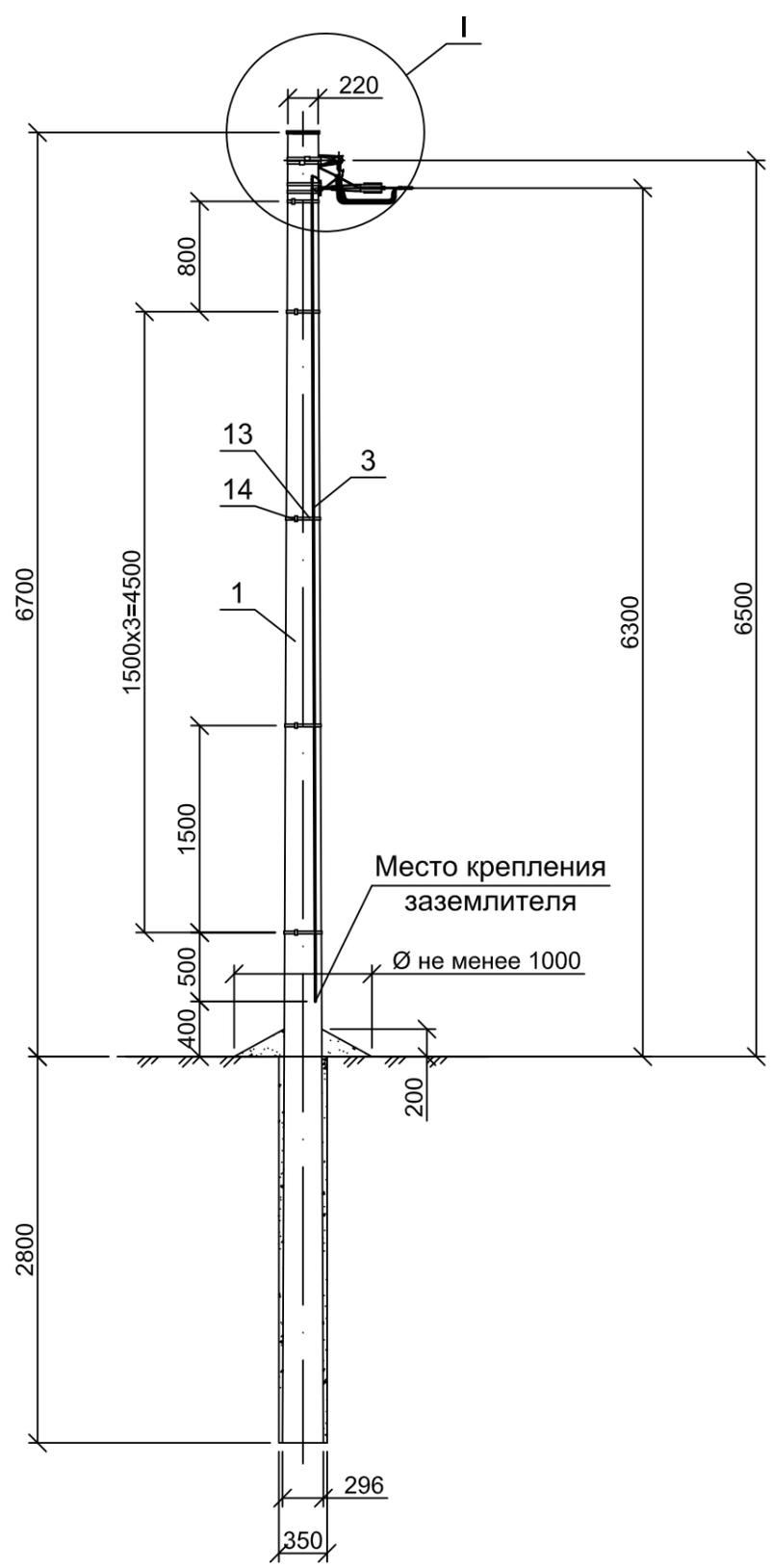
Схема установки стойки опоры
